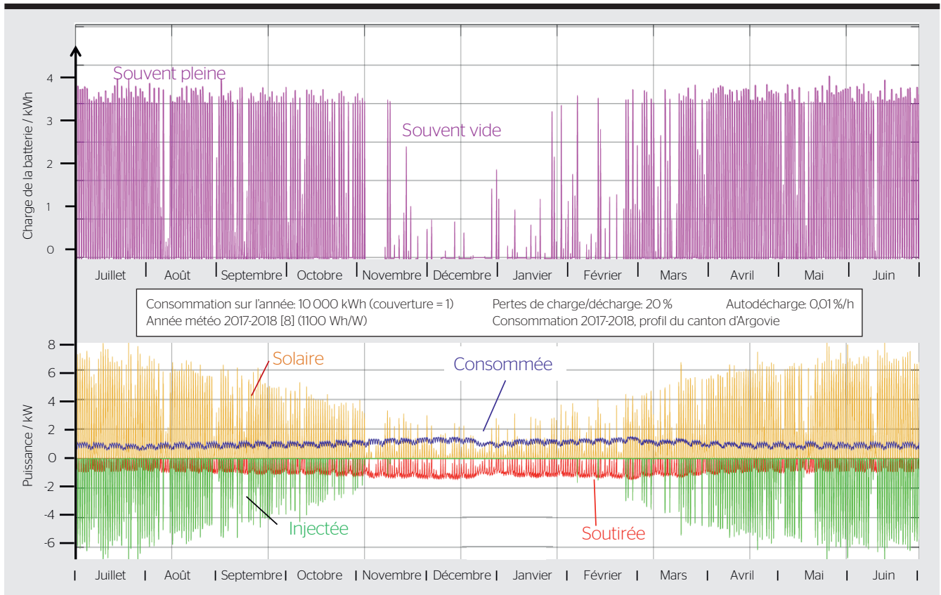
Figure 3 Charges de la batterie et puissances, d'été à été, avec une batterie de 4 kWh.
